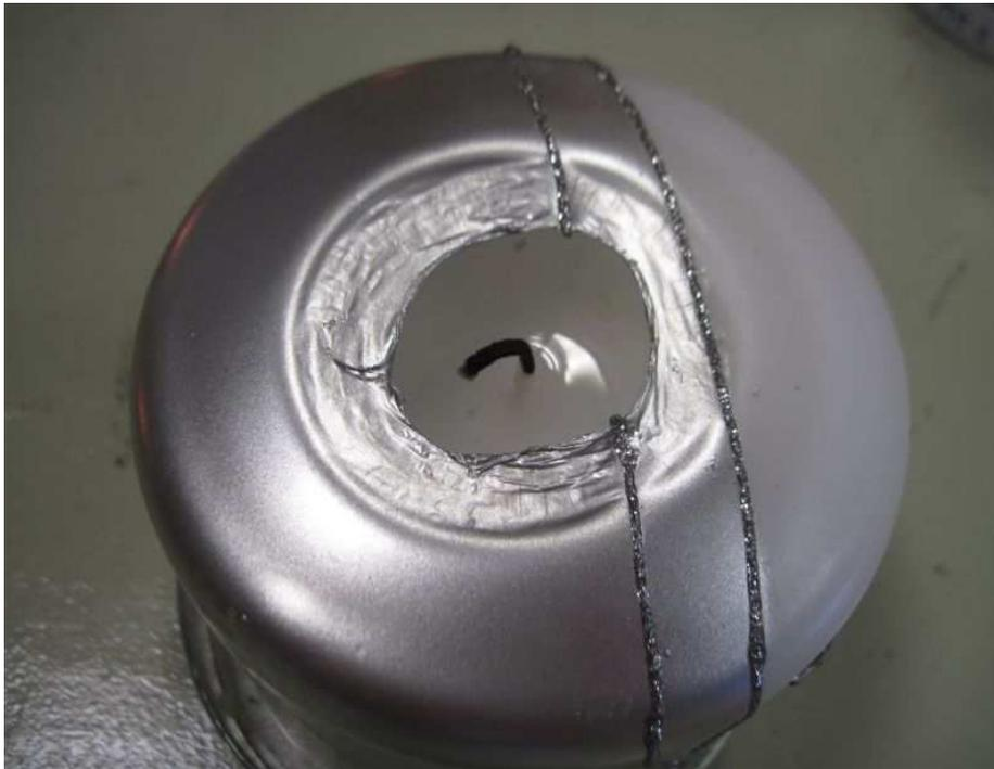
Entwicklung eines Hohlbrands durch zu kleine / schwache Flamme bzw. zu großer Durchmesser
