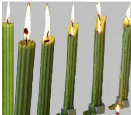
Abbildung 18: Bildung eines zweiten Dochtes durch abfallenden Butzen
